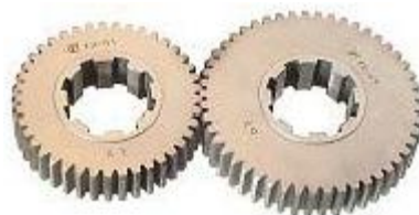
Koła zmianowe ustalające obroty Koła zmianowe ustalające takt maszyny Koła zmianowe do toczenia gwintu
