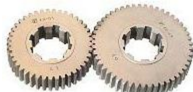
Koła zmianowe ustalające obroty Koła zmianowe ustalające takt maszyny Koła zmianowe do toczenia gwintu
