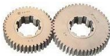
Koła zmianowe ustalające obroty Koła zmianowe ustalające takt maszyny Koła zmianowe do toczenia gwintu
